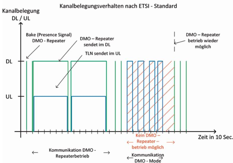
Die Diagrammdarstellung zeigt das Bakenverhalten des DMO-Repeaters nach ETSI-Standard. Die rot schraffierte Fläche stellt die Nichtverfügbarkeit des DMO-Repeaters dar. In dieser Zeit würden sämtliche Teilnehmer im DMO-Mode kommunizieren und damit immer wieder den DMO-Repeater als Objektfunkanlage außer Betrieb setzen.
